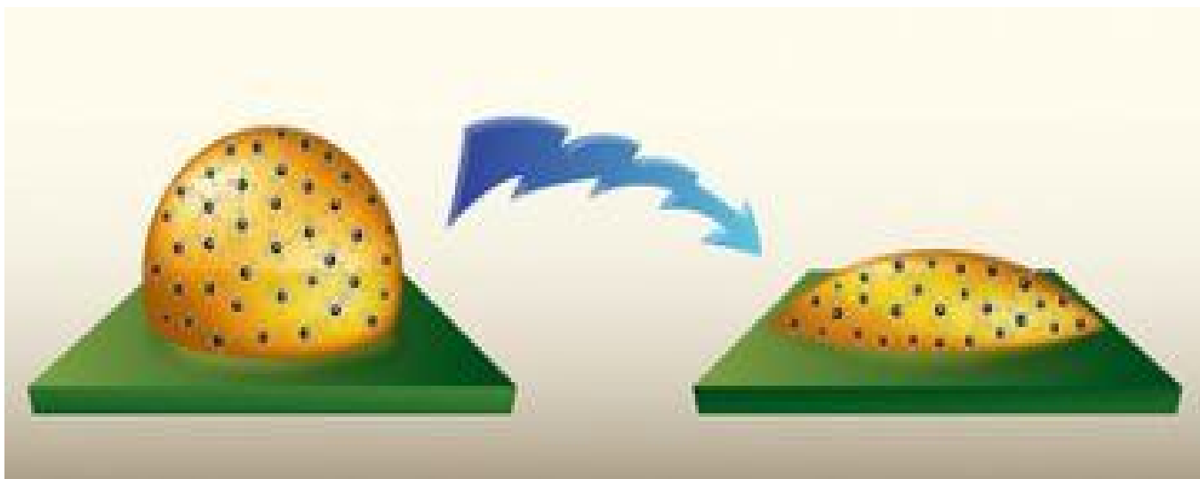
Изменение контактного угла жидкости при помощи электромагнитного поля
