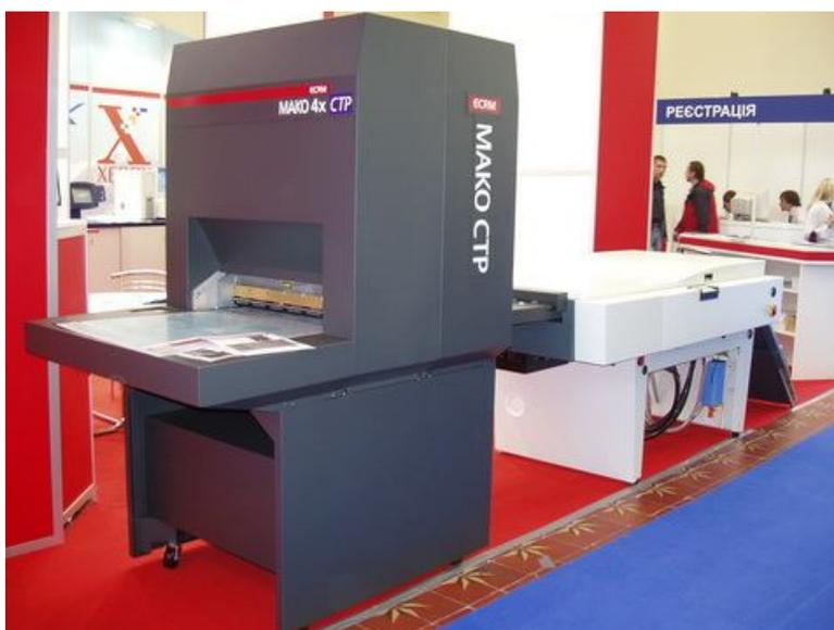
**4x** использованы всего 4 движущиеся детали: в направлении, перпендикулярном движению пластины, перемещается луч лазера, отраженный от вращающегося зеркала. Оптическая система является элементом рамной конструкции.
