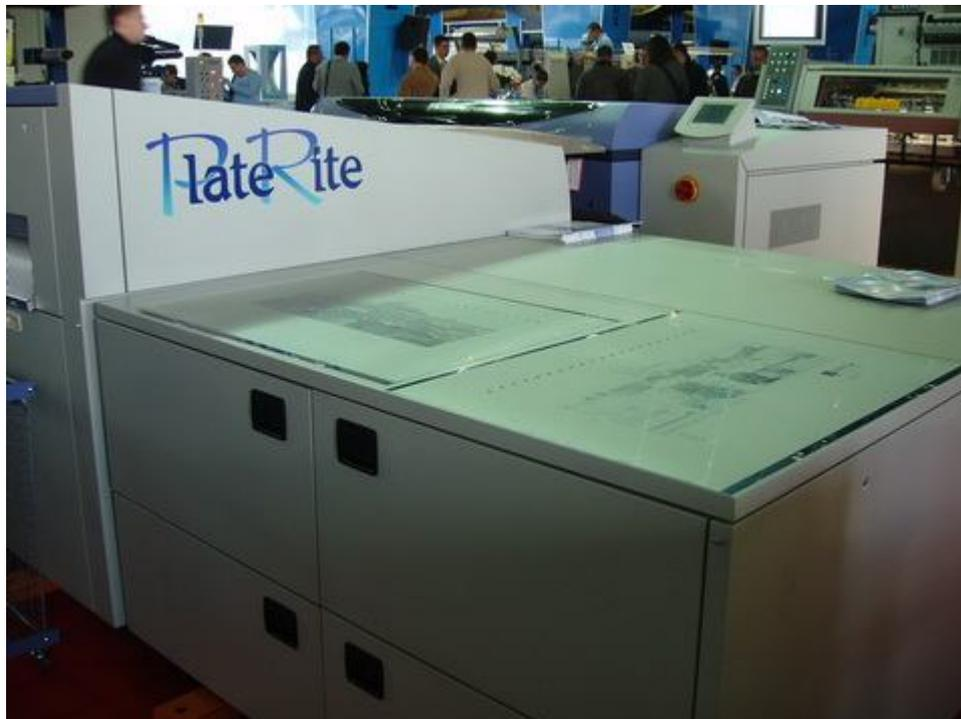
Использование надежной схемы построения с внешним барабаном, встроенная система пробивки до 8 типов штифтовых отверстий, автобалансировка барабана при смене формата - все это позволяет получить полностью готовые к печати формы на разные типы листовых и рулонных машин в кратчайшие сроки. Новая технология экспонирования GLV применяется на СТР устройствах **Screen PlateRite 8800** для улучшения качества и увеличения скорости экспонирования при замедленной скорости вращения барабана.
