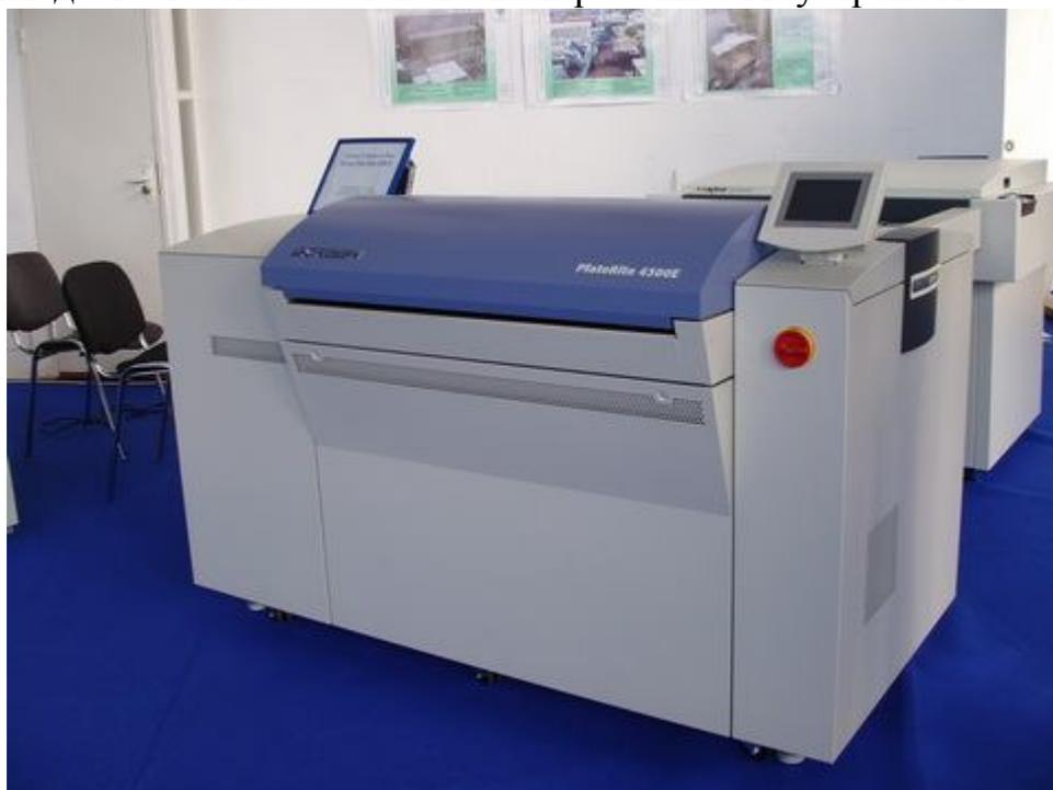
Автоматизация процесса подачи форм из кассет, разделения прокладочной бумаги, удаления пыли до момента экспонирования, надежная схема постороения с внешним барабаном, автоматическая регулировка баланса барабана при смене форматов - все это делает СТР системы **Screen**
