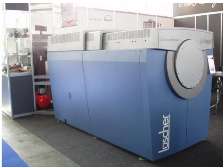
**Luscher Xpose 130 UV** можно оснастить устройством автоматизации - автоподатчиком и автопробойником штифтовых отверстий. В случае производственной необходимости машину можно переоборудовать для работы по термальной технологии.
