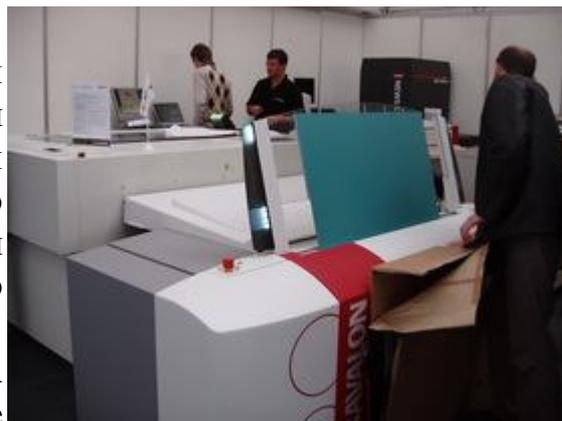
Аппарат **AGFA Avalon** имеет функцию динамического автофокуса для устранения дефектов из-за пыли, разной толщины пластин и других погрешностей. Технология GLV для увеличения скорости экспонирования при замедленной скорости вращения барабана и стабилизация энергии излучения лазерных диодов гарантируют надежность, долговечность, высокое качество и прекрасные производственные характеристики СТР устройства **AGFA Avalon**. Устройство занимает всего 2 кв.м помещения при однокассетной комплектации.
