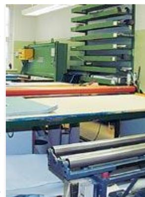
Для раскроя резино-тканевого полотна предназначен стол со специальными линейками и автоматическим резаком. Для размотки рулона используется установка с вращающимися валами.
